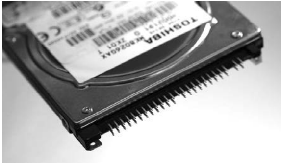
Figure 1-23: Mini IDE disk interface
