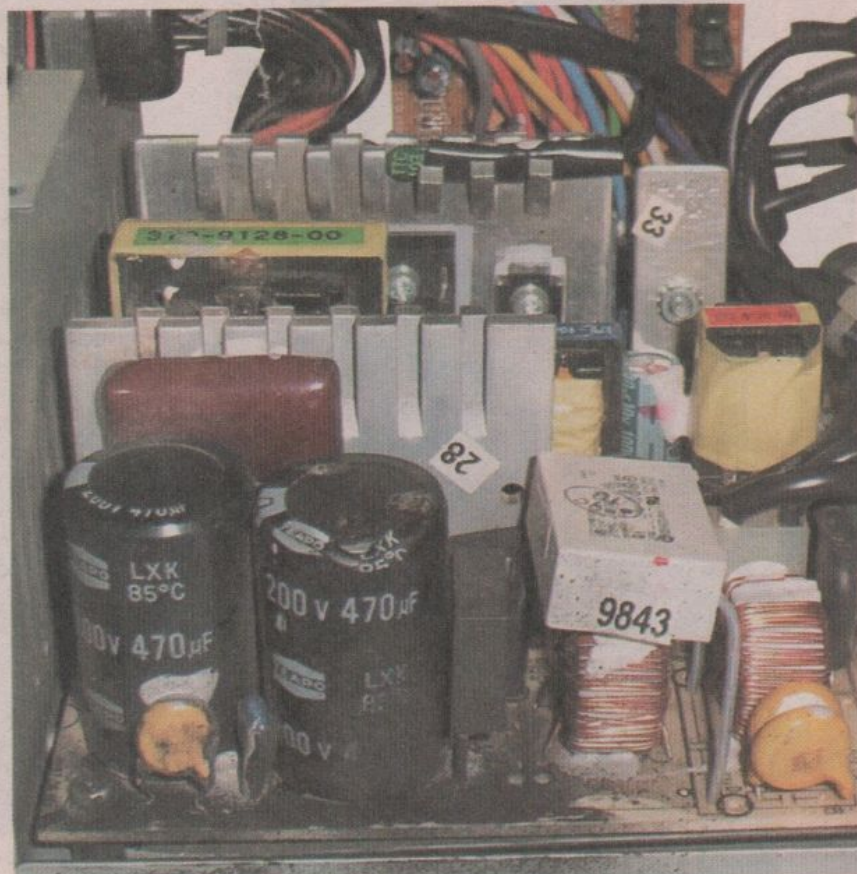
El circuito rectificador (que observamos a la izquierda de la imagen) prepara la energía que se distribuirá en el interior de la computadora.
