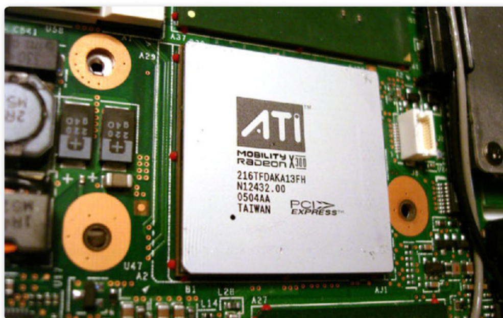
Figura 10. Algunos modelos de laptop mantienen visible la unidad de procesamiento gráfico sobre su placa madre.
