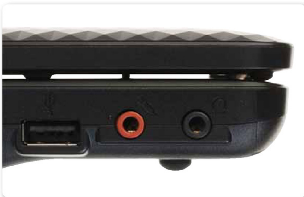
Figura 8. En las laptops actuales hay hasta dos Jack H 3.5 mm , uno para parlantes y audífonos, y el otro para el micrófono.
