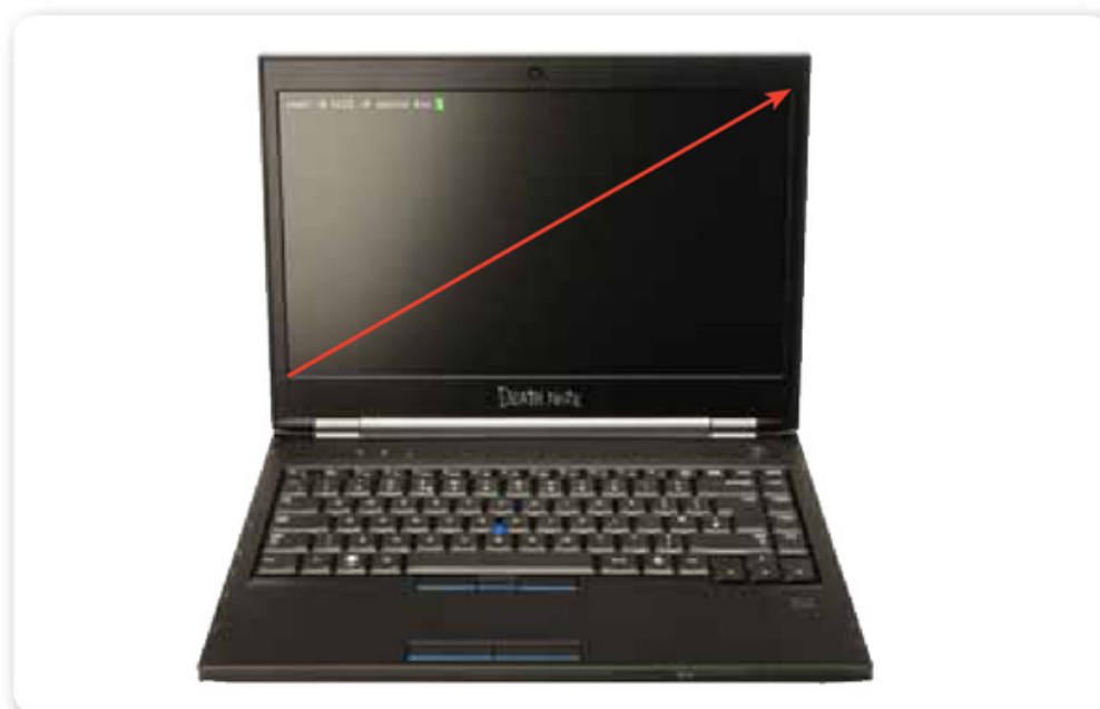
Figura 11. Las pulgadas en la pantalla de un equipo portátil varían de acuerdo con el fabricante o modelo de PC. La forma de medir el tamaño es tomando como base la esquina inferior izquierda y llegando hasta la esquina superior derecha, o en sentido contrario.
