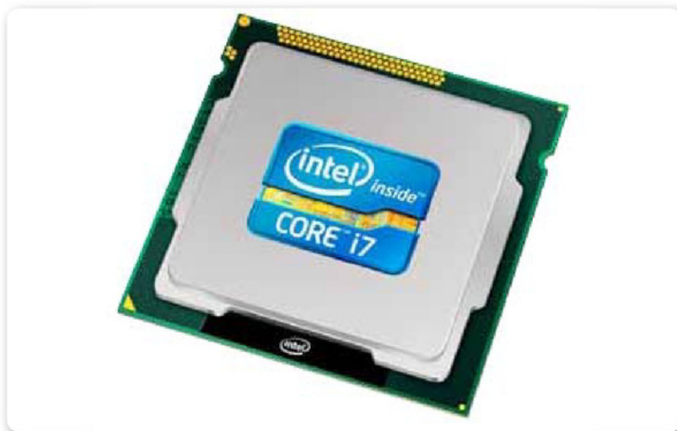
Figura 16. Las nuevas tecnologías de chipset unifican en un solo integrado GPU, CPU e IMC.
