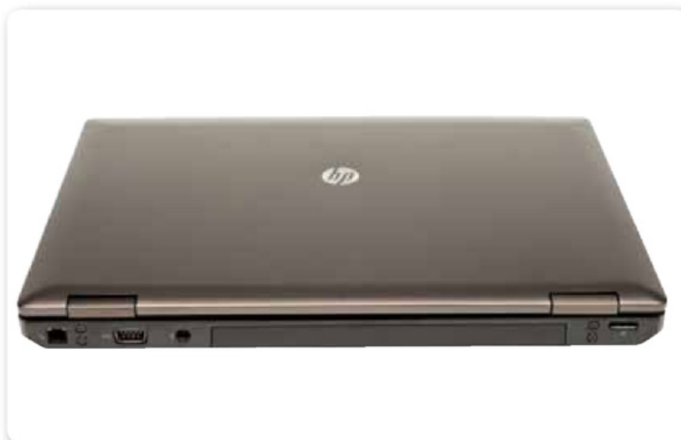
Figura 2. En algunos modelos de computadoras portátiles se incorporan puertos del onboard en la parte trasera de la PC.
