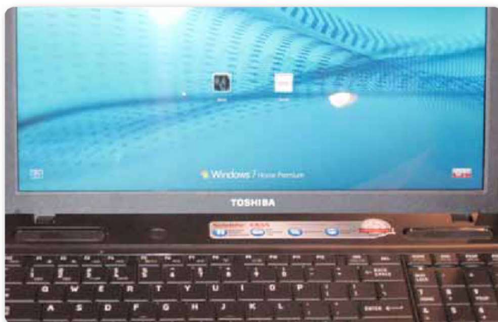
Figura 14. El monitor o pantalla LCD es un ejemplo de periférico externo de salida de datos en una computadora portátil.
