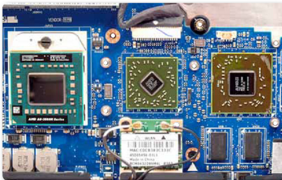
Figura 10. Una computadora portátil, al igual que una PC de escritorio, cuenta con un GMCH ( Graphic and Memory Controller Hub ) y un ICH ( I/O Controller Hub ).
