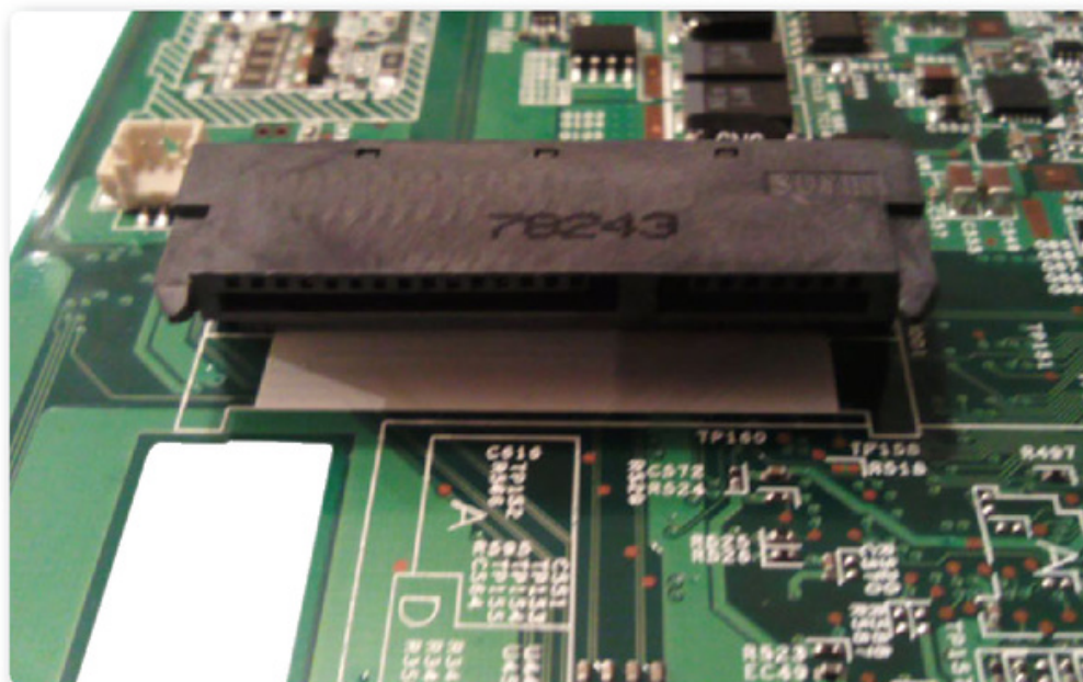
Figura 14. En la imagen se aprecia el conector SATA ubicado en el motherboard de una PC portátil.
