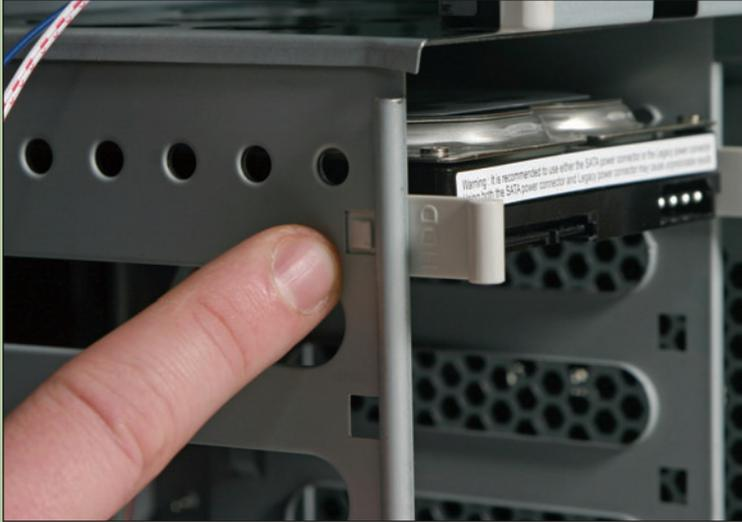
**4** El paso siguiente es conectar el cable de alimentación del disco duro. En este caso se trata de un disco con tecnología SATA que posee un conector de 15 pines y una muesca de posición para enchufarlo correctamente.
