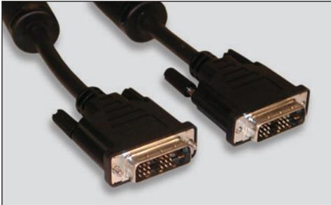
Por lo tanto, el hecho de tener la conexión DVI en los dos extremos (placa de video y monitor LCD) ayudará en gran medida a mejorar la imagen final del monitor LCD.
