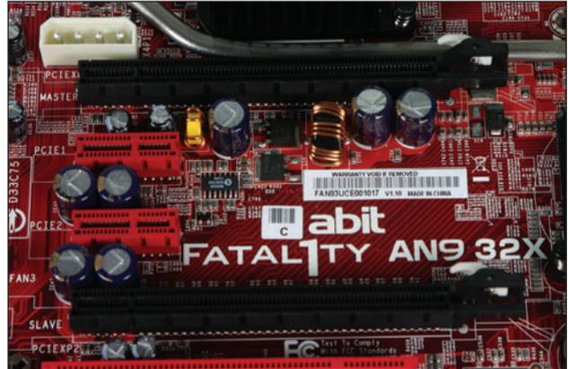
**Figura 38.** Los motherboards tienen la marca y el modelo impreso en su superficie.
