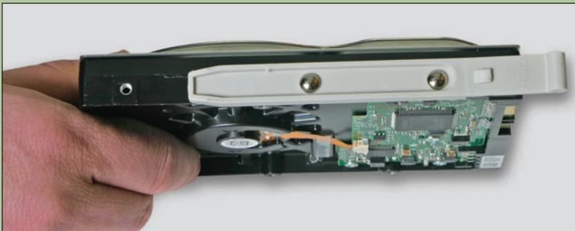
**2** Una vez que colocó las guías en el disco duro, tendrá que ensamblar el dispositivo en la bahía de 3.1/2 pulgadas.
