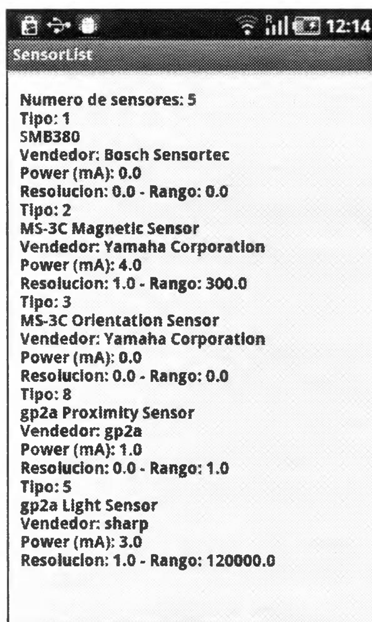
Figura 5.2. Lista de sensores en un teléfono Samsung Galaxy S.
