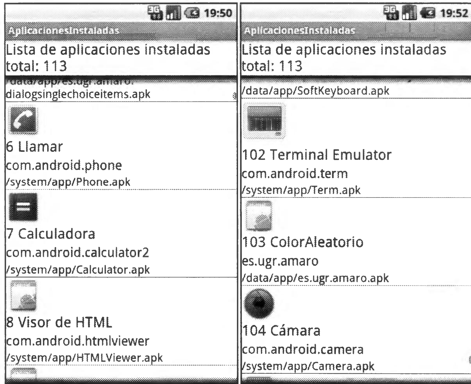
Figura 11.7. Una aplicación con un ListView que muestra todas las aplicaciones instaladas, usando el PackageManager . Las aplicaciones pueden abrirse al pulsar cada ítem.
