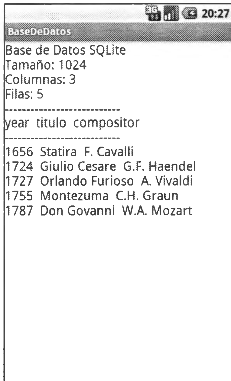
Figura 9.4. Tres columnas de la tabla de óperas tras insertar dos filas más. El año aparece en primer lugar y las filas están ordenadas por año de estreno.
