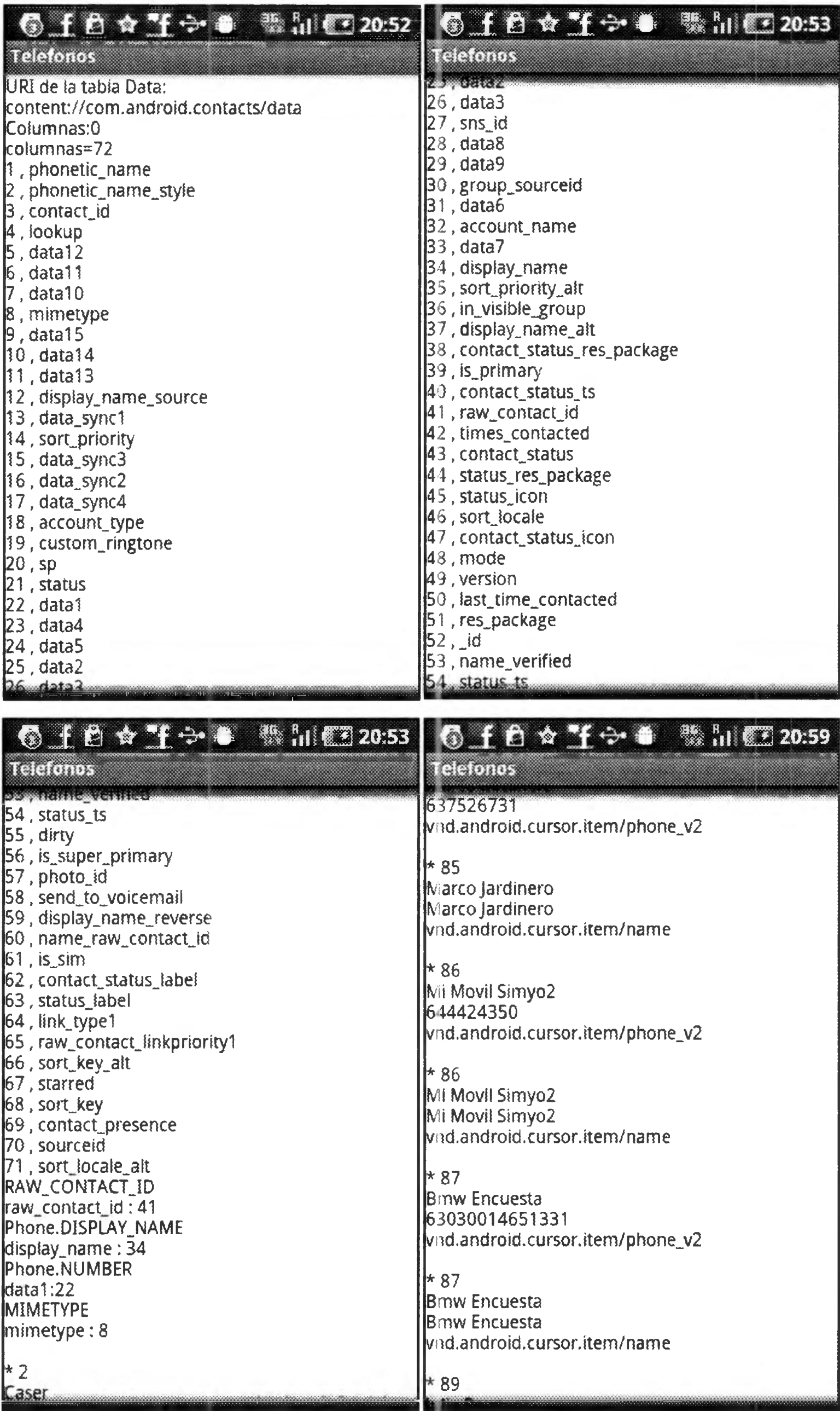
Figura 10.2.2. Contenidos de la tabla de datos en un teléfono Samsung Galaxy S con Android 2.2.1.
