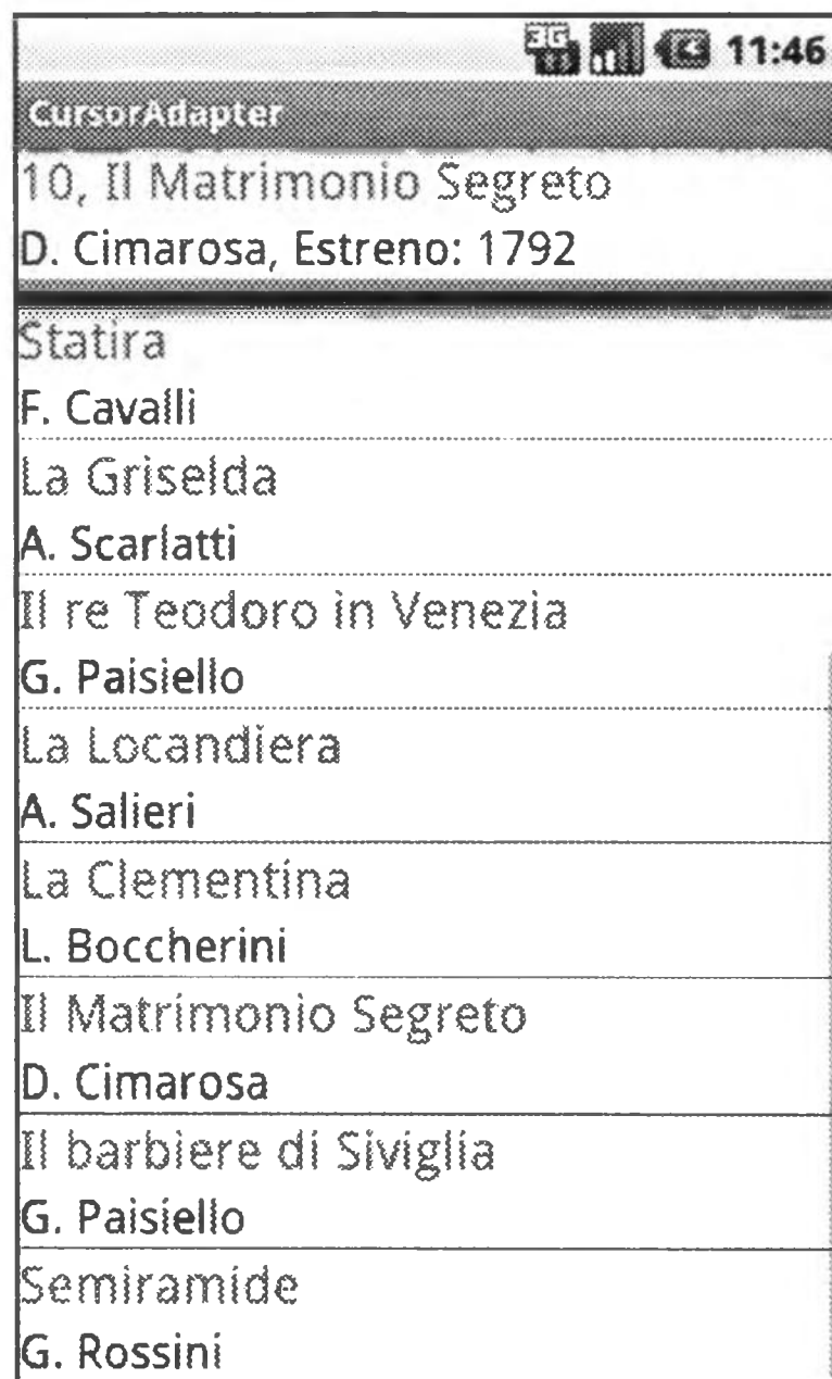
Figura 9.8. Contenidos de una base de datos visualizados en un ListView usando un SimpleCursorAdapter .
