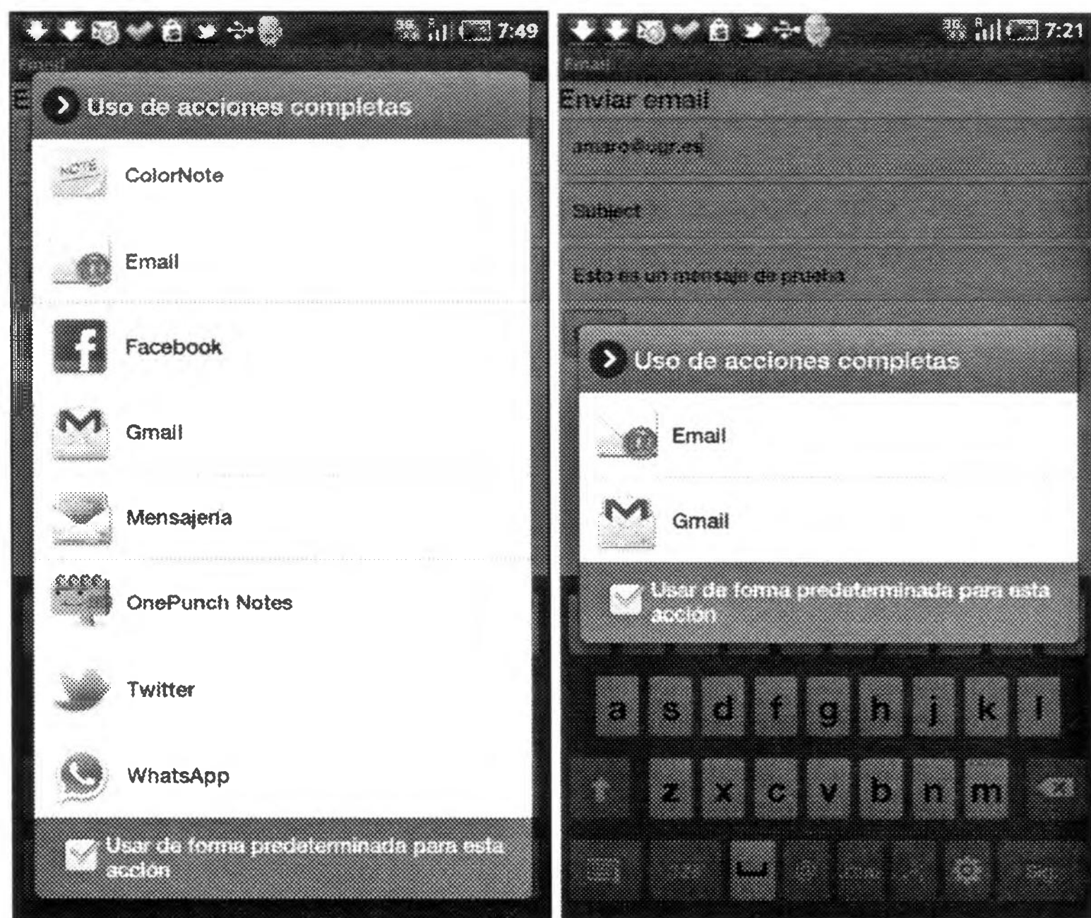
Figura 13.1.2. Cuadro de diálogo al abrir una actividad implícitamente con el tipo MIME text/plain (izquierda) y plain/text (derecha).
