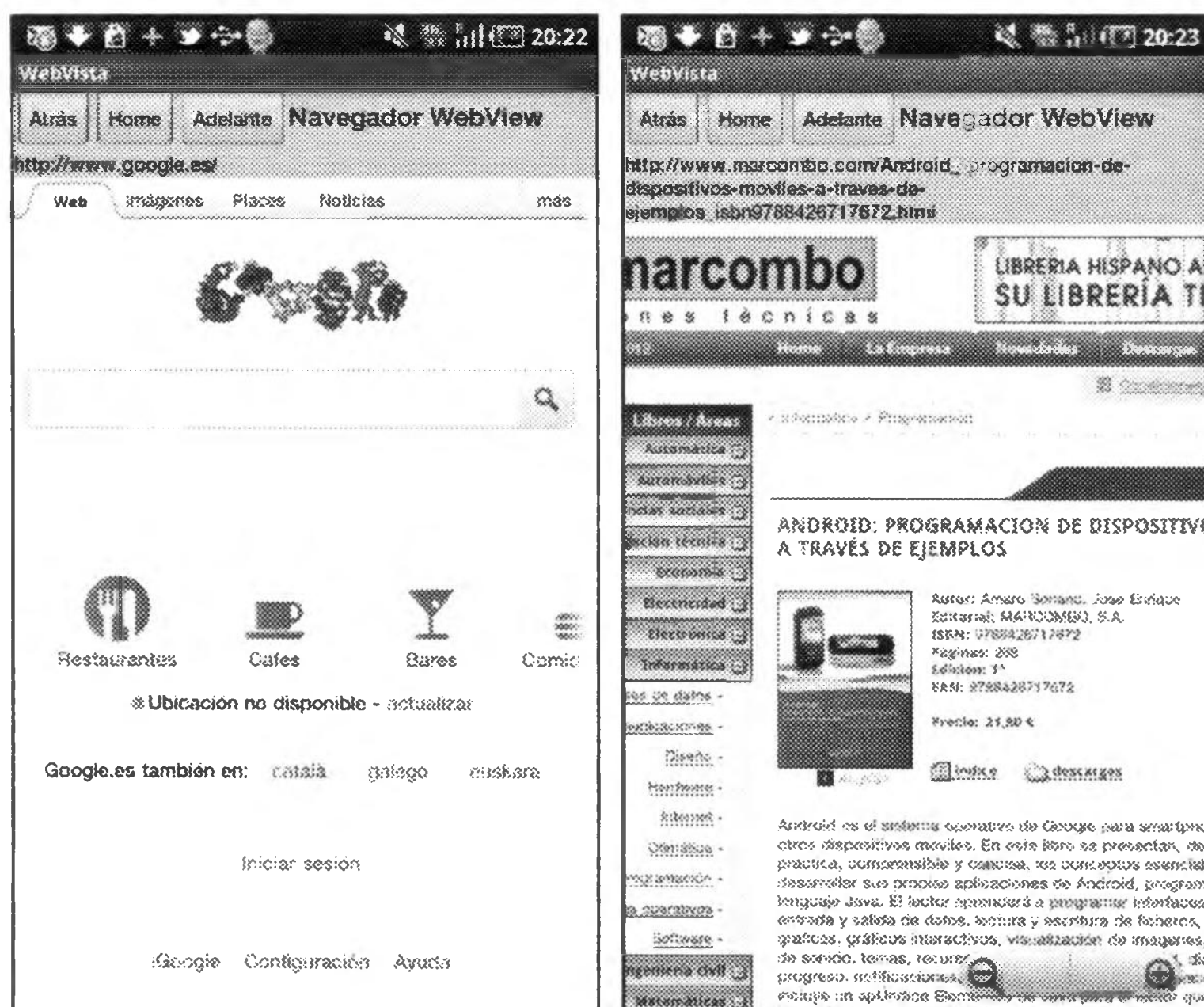
Figura 12.2. Un sencillo navegador que usa WebView para incrustar una página web en un layout. Las capturas de pantalla son de un tablet Samsung Galaxy Tab, de la página principal de Google y después de realizar una búsqueda. Obsérvense los controles de zoom que aparecen en la parte inferior de la pantalla.
