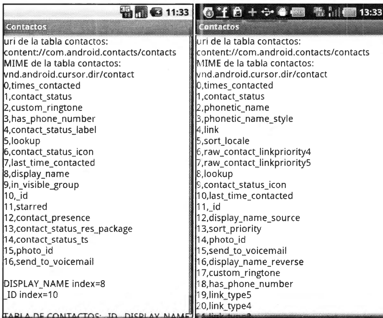
Figura 10.1.1. Izquierda: contenidos de la tabla de contactos en un emulador con Android 2.1 (Eclair). Derecha: en un teléfono Samsung Galaxy S con Android 2.2.1 (Froyo).
