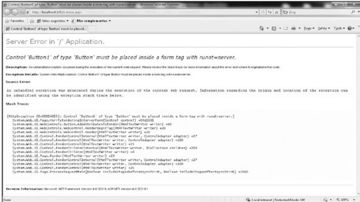
**Figura 13.** Al no poder manejar los controles que están por fuera de la etiqueta de formulario, la página ASP.net nos arrojará un error que deberemos corregir para que pueda funcionar correctamente.
