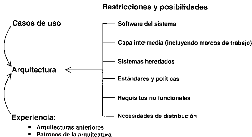
Figura 4.1. Existen diferentes tipos de requisitos y productos que influyen en la arquitectura, aparte de los casos de uso. También son de ayuda en el diseño de una arquitectura la experiencia de trabajos anteriores y las estructuras que podamos identificar como patrones de la arquitectura.
