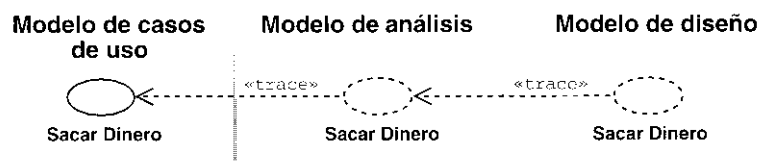
Figura 3.7. Realizaciones de caso de uso en diferentes modelos.
