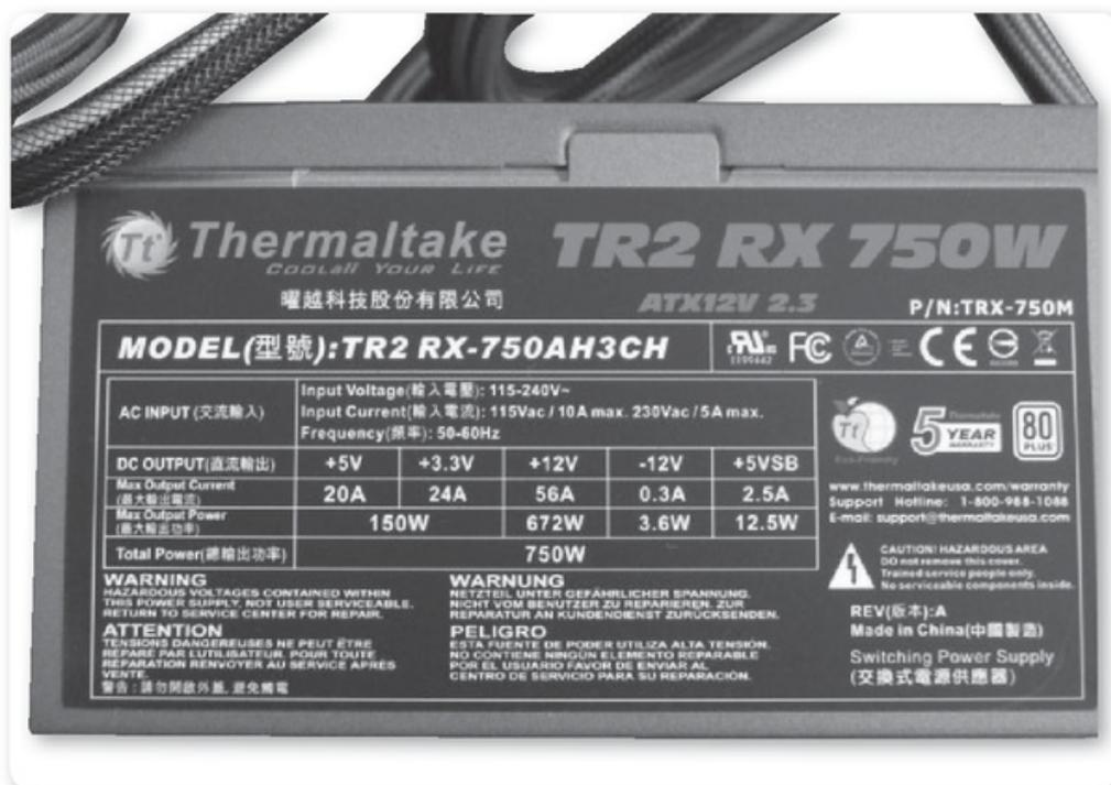
► **Figura 21.** Fuente de la marca **Thermaltake** modelo TR2 RX 750W, con certificación **80 Plus** a la derecha.
