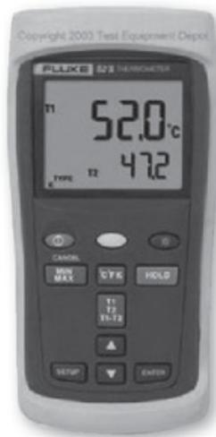
► **Figura 10.** Un termómetro de la reconocida marca Fluke. Es necesario seleccionar la correcta termocupla.
