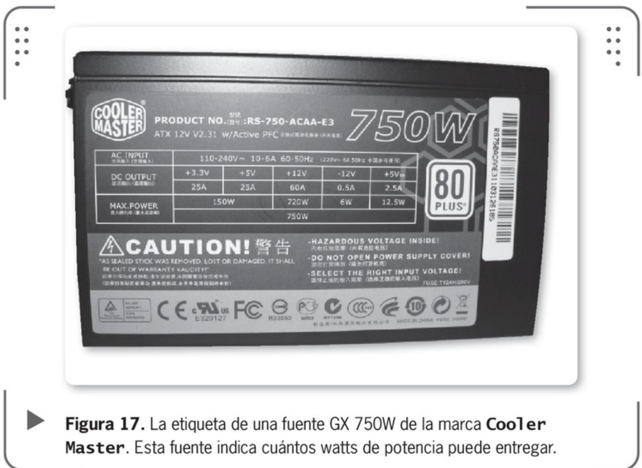
► **Figura 17.** La etiqueta de una fuente GX 750W de la marca **Cooler Master**. Esta fuente indica cuántos watts de potencia puede entregar.
