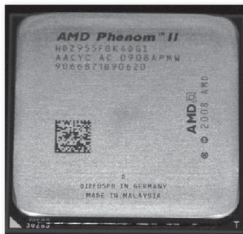
► **Figura 12.** El microprocesador de 4 núcleos Phenom II 955. Este procesador puede manejar velocidades asombrosas.
