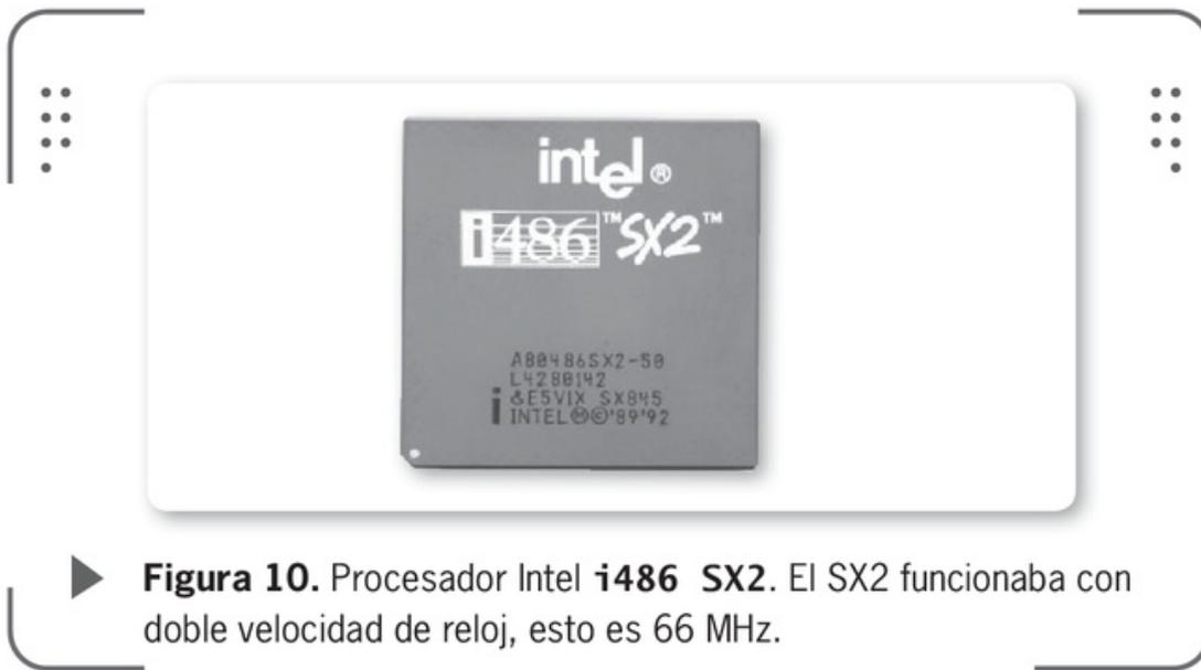
► **Figura 10.** Procesador Intel **i486 SX2**. El SX2 funcionaba con doble velocidad de reloj, esto es 66 MHz.
