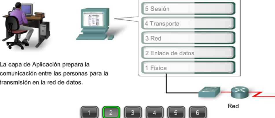
La capa de Aplicación prepara la comunicación entre las personas para la transmisión en la red de datos.
