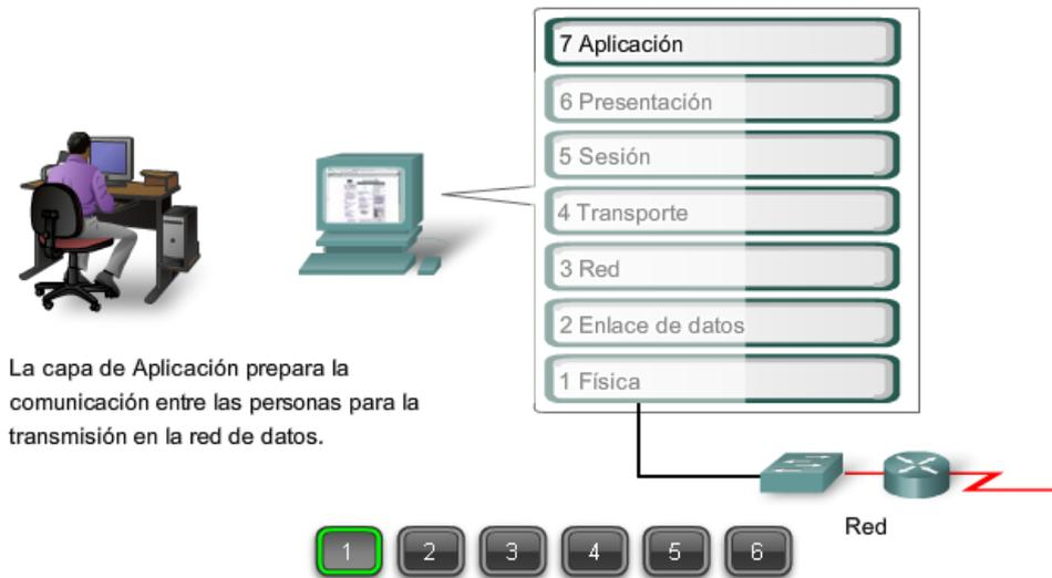
La capa de Aplicación prepara la comunicación entre las personas para la transmisión en la red de datos.
