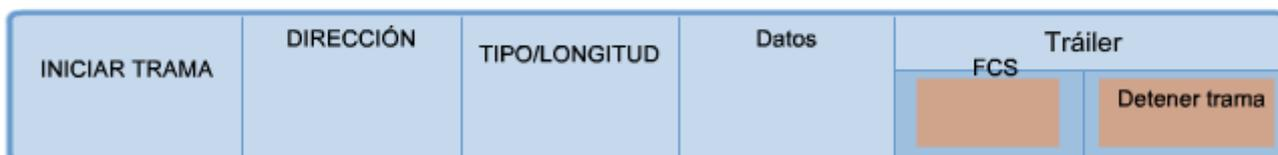
Se utiliza el campo **Secuencia de verificación de trama** para controlar los errores. El origen calcula un número en función de los datos de la trama y coloca ese número en el campo FCS. El destino, entonces, recalcula los datos para determinar si FCS coincide. Si no coinciden, el destino elimina la trama.
