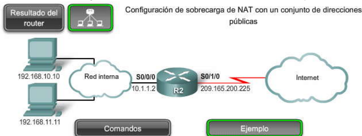
Configuración de sobrecarga de NAT con un conjunto de direcciones públicas
