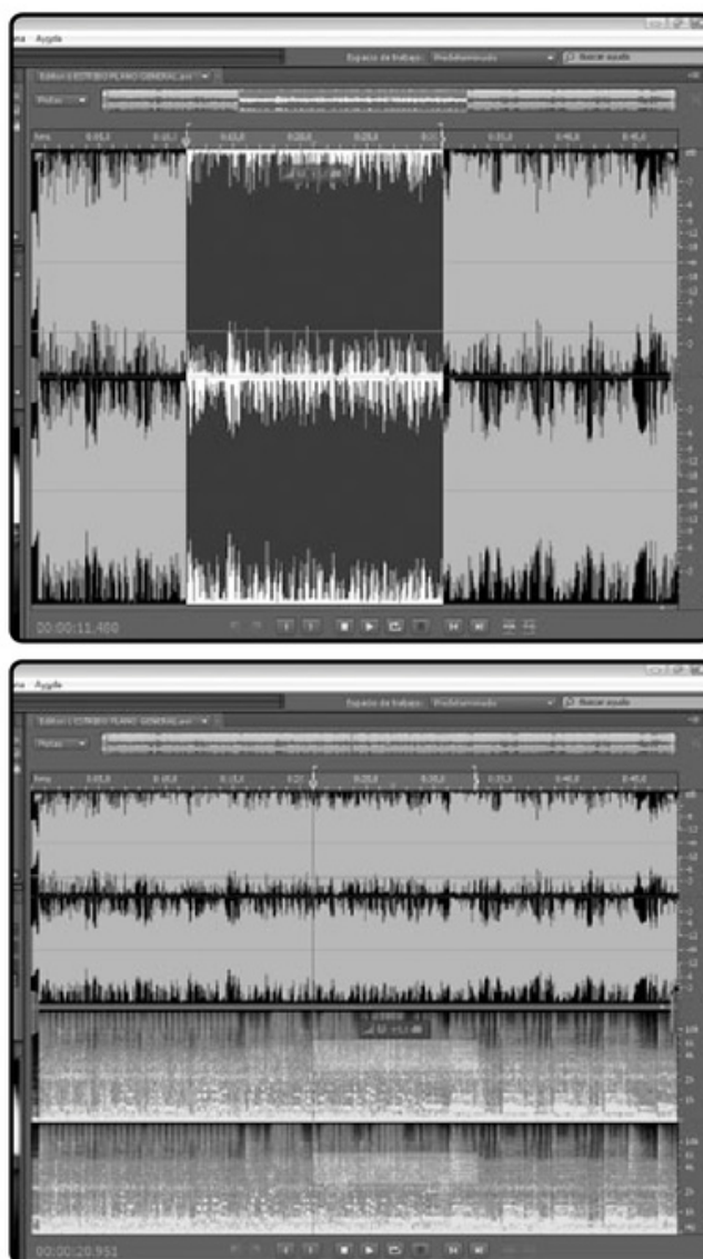
FIGURA 6. En la primera imagen vemos la herramienta Selección directa, que permite elegir cualquier fragmento del archivo de audio. Luego, Recuadro rectangular, para seleccionar frecuencias determinadas en un rango de tiempo.
