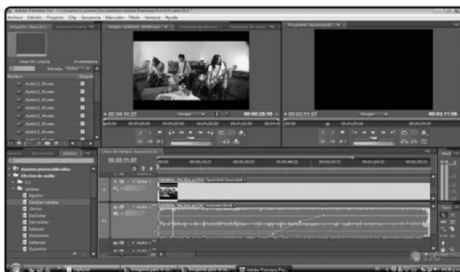
FIGURA 1. Las bandas de goma (Rubber Banding) corren a lo largo de la pista de audio para graficar el valor de ganancia.
