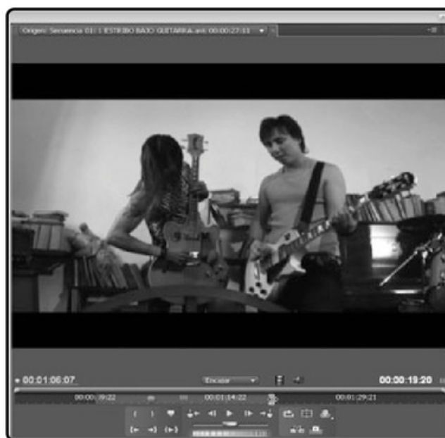
FIGURA 1. Ventana de previsualización en Premiere CS4, con marcadores de entrada (set in point) y de salida (set out point).
